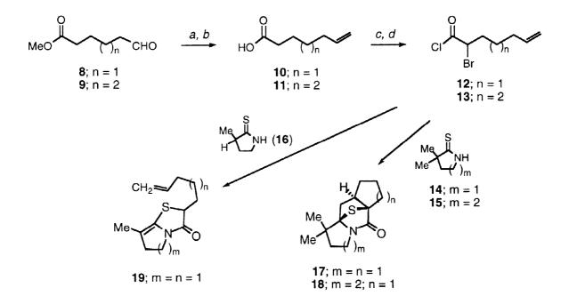
Reagents: (a) Ph<sub>3</sub>P=CH<sub>2</sub>; (b) KOH/MeOH; (c) LDA/CBr<sub>4</sub>; (d) (COCl)<sub>2</sub>
